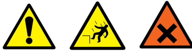
Figura 1. Ejemplos de señales de advertencia. De izquierda a derecha: peligro indeterminado, peligro caída a distinto nivel y peligro materias nocivas e irritantes. [5]
