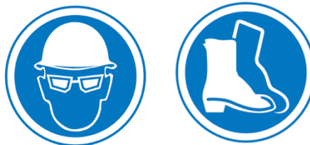
Figura 3. Ejemplos de señales de obligación. De izquierda a derecha: uso obligatorio de casco y gafas, uso obligatorio de calzado de seguridad. [5]
