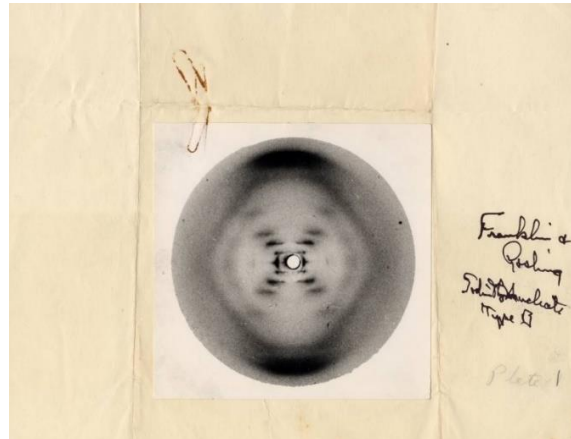
Figura 40: Imagen de rayos X del ADN en su forma B, denominada “Photograph 51”, tomada por R. G. Gosling y R. E. Franklin en 1952. 255c
