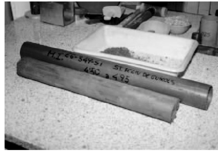
Figura 2.2: Mostra inalterada protexida nunha funda de PVC
