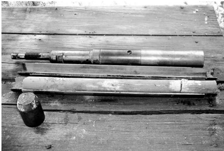
Figura 7.2: Imaxe da culler SPT coa mostra de solo no seu interior
