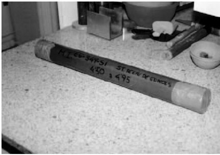
Figura 2.2: Mostra inalterada protexida nunha funda de PVC
