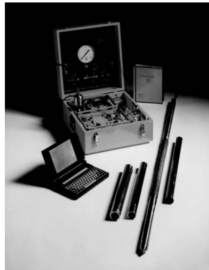
Figura 9.2: Imaxes da sonda presiométrica e o equipo de control do ensaio de Menard
