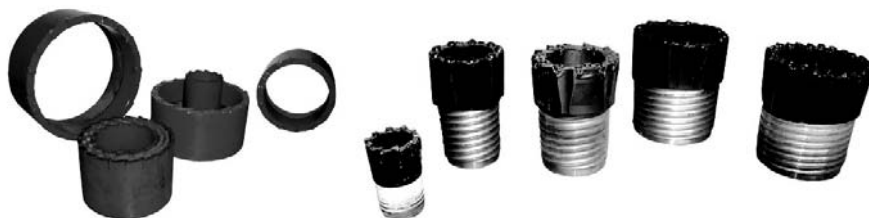
Figura 4.7: Coroas para a realización de sondaxes a rotación con extracción de testemuño
