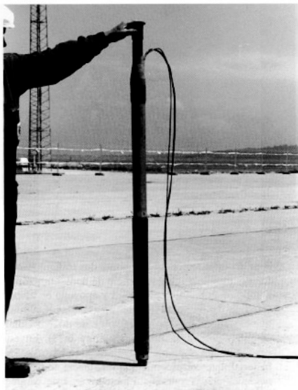
Figura 9.2: Imaxes da sonda presiométrica e o equipo de control do ensaio de Menard
