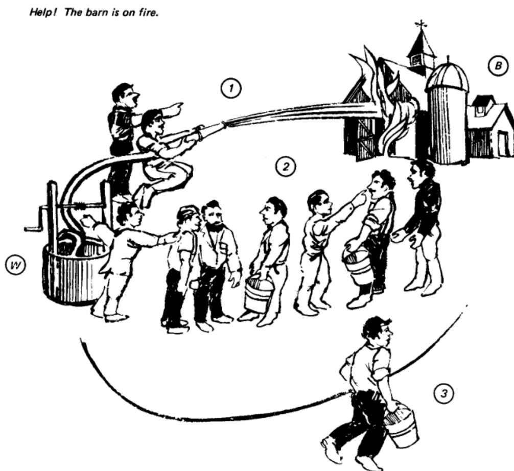
Figura 1.2: Analogía dos tres modos de transmisión da calor. Camiño 1: A manguera transmite directamente a auga ao lume sen necesidade dun medio. É o análogo á radiación. Camiño 2: As persoas vanse pasando cubos de auga para apagar o lume. É o análogo á conduction. Camiño 3: Un simple corredor, representando o medio, leva a auga ata o incendio. É o análogo á convección. Tomado de [5]
