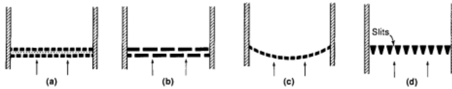
Figura 11. Tipos de platos perforados. Fuente [24]
