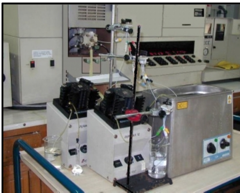
Figura 13. Fotografías del sistema FIA usado para la determinación de cobre cinc, cobre, hierro y manganeso en muestras sólidas de naturaleza alimenticia, donde se puede observar el acoplamiento con la AAS con llama.
