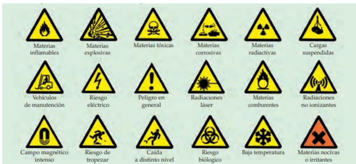
Figura 1. Señales de advertencia. Fuente: [14]
