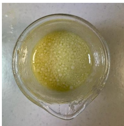
Figura 45. Emulsión del sistema S2B donde se observa separación de fases por floculación por agotamiento
