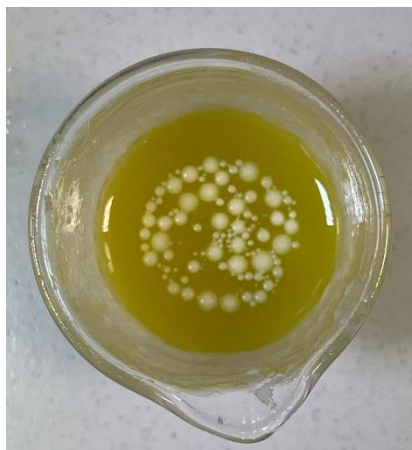
Figura 56. Emulsión del sistema S3A con separación de fases por fenómenos de agregación
