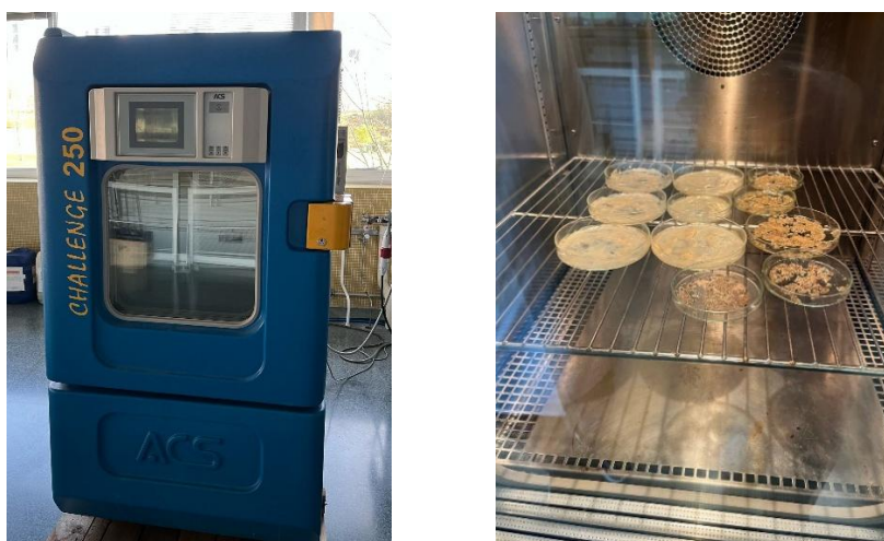
Figura 18. Secadero convectivo Angelantoni Challenge 250 y disposición de las placas con emulsión durante el proceso de secado
