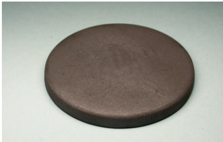
Figura 4.20.- Disco de silicio tras un tratamiento a 350°C.
