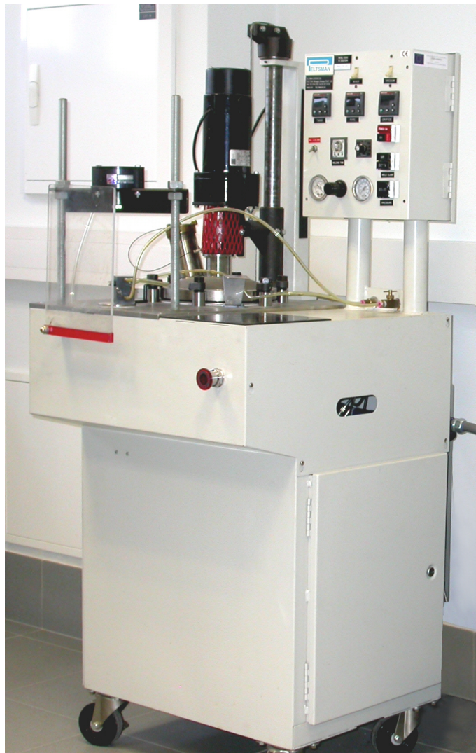
Figura 3.8. – Máquina Peltzman de moldeo por inyección a baja presión modelo MIGL-33.
