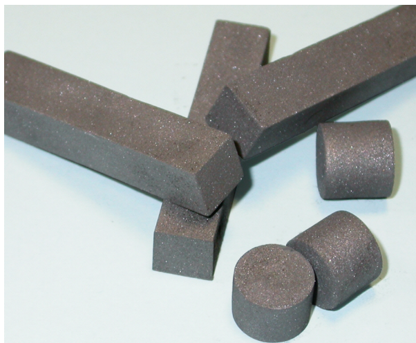
Figura 4.17.- Aspecto de las probetas después de un ensayo de eliminación de aglomerantes con grafito de tamaño <125\ \mu\text{m} .
