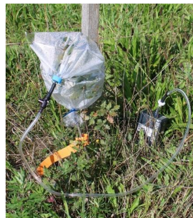
Figura 2. Bomba de extracción de compuestos orgánicos volátiles en uno de los robles de estudio.
