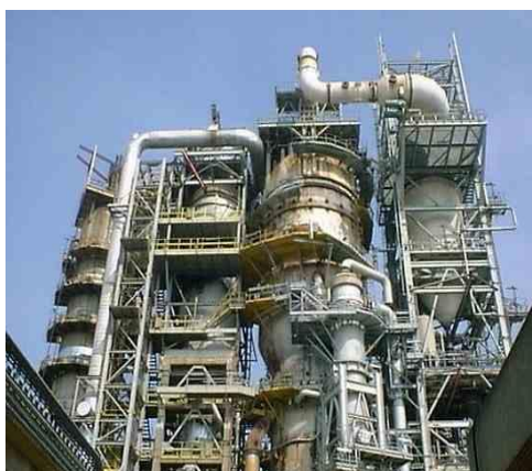
Figura 41. Reactor de lecho fijo para la isomerización de butano con una capacidad de 20000 BPD (barriles por día). Fuente: (43).
