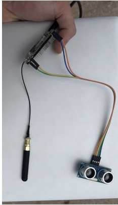
(a) Montaje inicial de placa de desarrollo y sensor de ultrasonidos.
