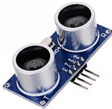
Figura 3.7: Sensor HC-SR04 (fuente: [47]).
