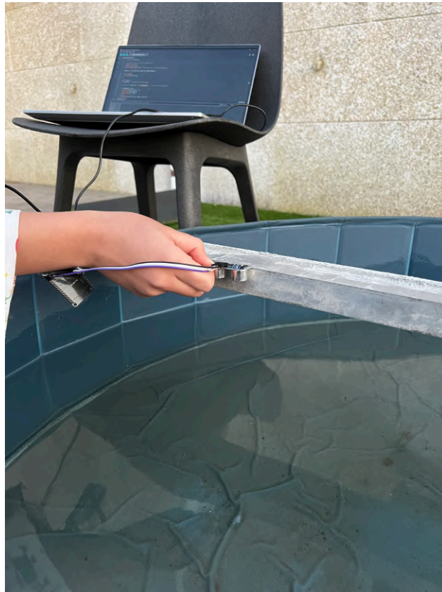
Figura 5.1: Pruebas del sensor HC-SR04 sobre agua.
