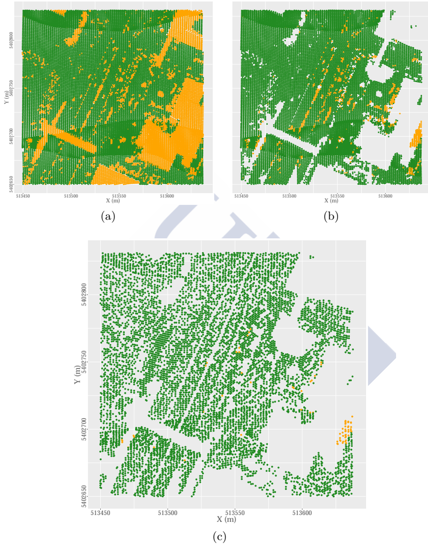
Figura A.15: Muestra 22: Efectividad del proceso de depurado. Donde: a) nube de puntos original clasificada en P_g (verde) y P_{ng} (amarillo); b) nube de puntos resultante del proceso de depurado y c) nube de puntos semilla.
