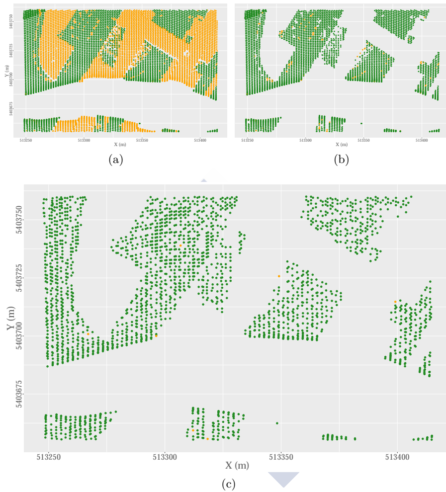
Figura A.19: Muestra 41: Efectividad del proceso de depurado. Donde: a) nube de puntos original clasificada en P_g (verde) y P_{ng} (amarillo); b) nube de puntos resultante del proceso de depurado y c) nube de puntos semilla.
