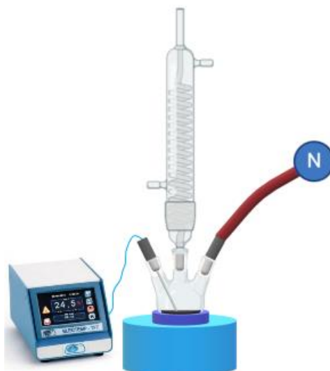
Figura 9: Esquema del montaje para la síntesis de MNPs.
