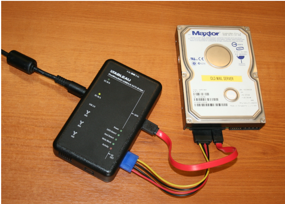
Figura 1.1: Bloqueador físico de escritura. Este dispositivo impide cualquier intento de modificación en el disco duro conectado. Fuente: Wikimedia Commons
