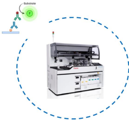
Figura 5. Plataforma ImmunoCAP-250© en la que el alérgeno se encuentra embebido en una esponja (fase sólida). Imagen cortesía del Dr. Moisés Labrador Hornillos (Servicio de Alergología, Hospital Vall de Hebrón).
