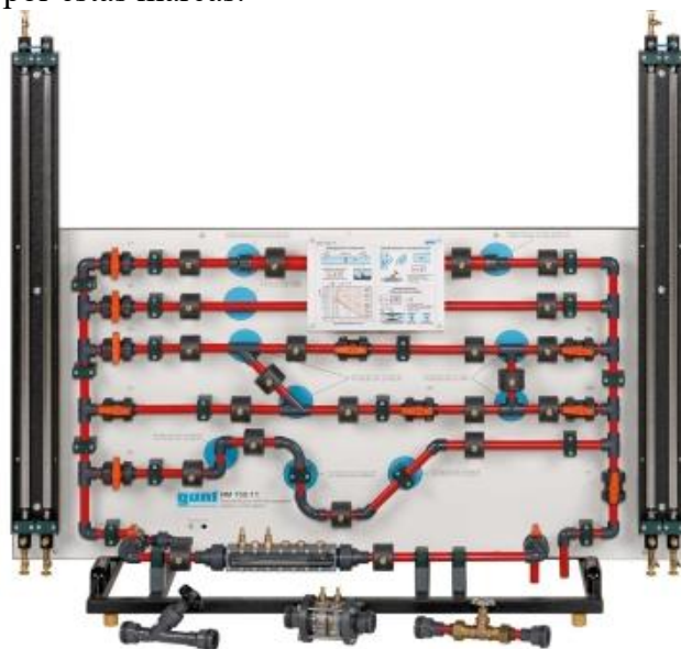
Figura 2. Instalación HM 150.11: estudio de pérdidas de carga en un sistema de tuberías, casa comercial Gunt (1).
