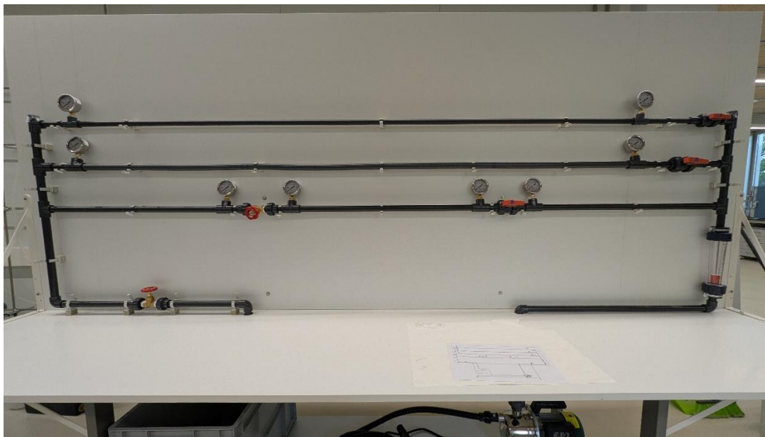
Figura 13. Planta fluidodinámica con las líneas 0, 1, 2 y 3 colocadas.
