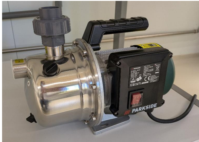
Figura 4. Bomba centrífuga Parkside PTPS 1100.
