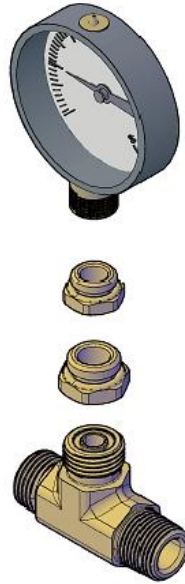
Figura 3. Conexión del manómetro con las tuberías de 3/4 a de la instalación.
