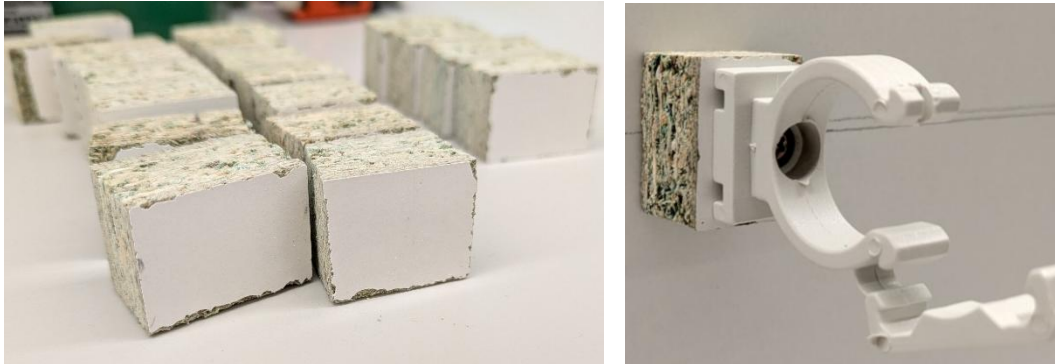
Figura 9. Izquierda: fragmentos de tablero; derecha: colocación de las abrazaderas.
