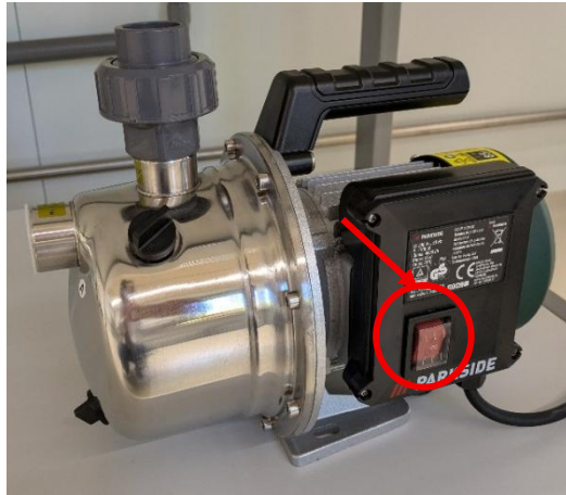
Figura 7. Ubicación del interruptor de la bomba centrífuga.
