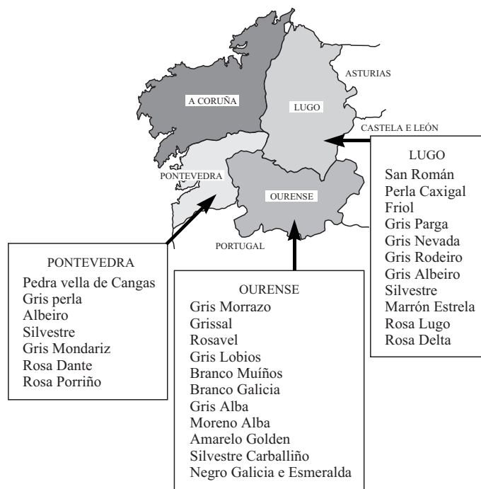
Figura 2.- Localización xeográfica dos distintos tipos de granitos galegos
