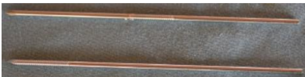
Figura 26: Clavo de perfil positivo, el superior con rosca en el centro y el inferior en el extremo (Wander, 2019).
