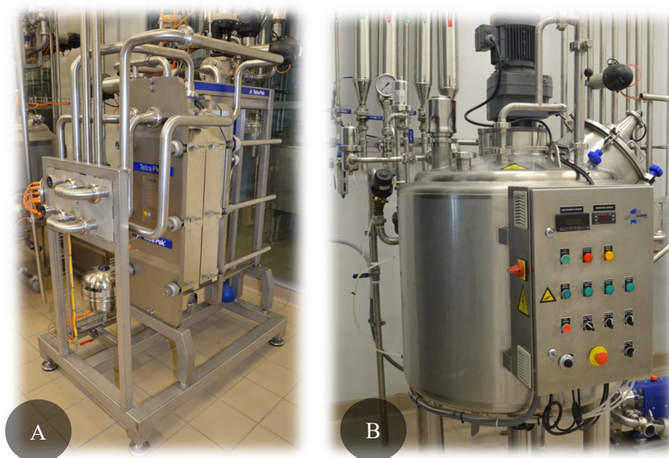
Figura 15. A) Intercambiador de calor de placas (Tetra Pak) (tomada de: https://aplta.es/wp-content/uploads/2021/05/APLTA-Linea-de-pretratamientos-y-mezclas.pdf ) y B) Depósito para la hidrólisis (Pierre Guerin) (tomada de: https://aplta.es/wp-content/uploads/2021/05/APLTA-Linea-de-productos-fermentados.pdf )
