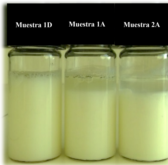
Figura 51. Hidrolizados tratados térmicamente a temperatura de pasteurización en un intercambiador tubular (muestra 1D, muestra 1A y muestra 2A) tras 40 días almacenadas en refrigeración
