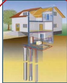
Captación geotérmica vertical cerrada
