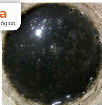
Lodo Digerido EDAR Guillarei
