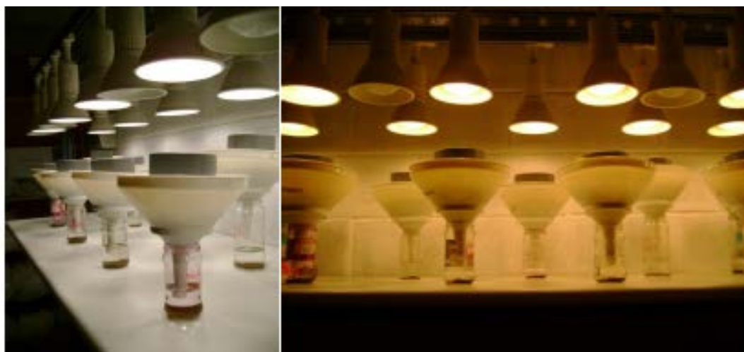
Figura 3.8. Sistema de extracción da fauna edáfica por medio de funís Berlese – Tullgren.
