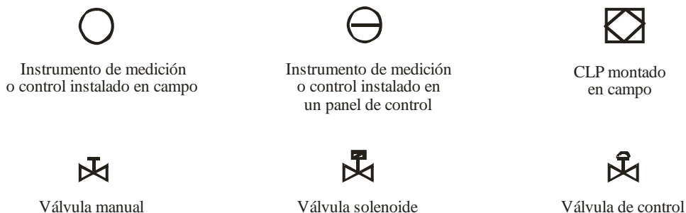
Figura 1.5. Simboloxía da instrumentación nos diagramas P&I
