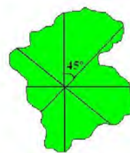
Figura 21: Medición do diámetro de copa nunha árbore con copa irregular. D = (a+b+c+d)/4
