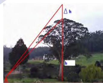
Figura 14: Exemplo de medición de altura en árbores de copa frondosa (Eucalipto da Casa de Reimunde)
