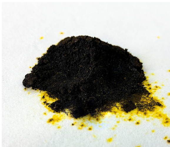
Figura 3. Apariencia física del tricloruro de hierro anhidro. Al tratarse de un compuesto delicuescente, su exposición a la humedad del aire provoca la aparición de las manchas amarillas que se observan en la imagen.
