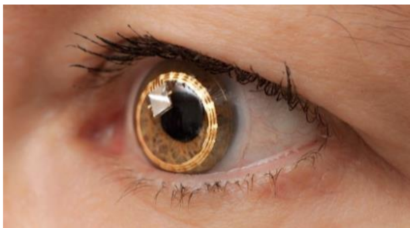
Figura 19. Lente de contacto telescópica. Figura extraída de: Discapacidad Otros Ciegos de España. Unas lentillas con un pequeno telescopio ayudarán a pacientes con degeneración macular [Internet]. Asociación D.O.C.E. 2015 [fecha de consulta 29 de maio do 2024]. Dispoñible en: https://asociaciondoce.com/2015/03/17/unas-lentillas-con-un-pequeno-telescopio-ayudarian-a-pacientes-con-degeneracion-macular/
