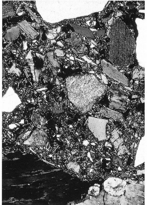
Figs. 1 a 4: 1. Roca granítica fresca. Nícoles cruzados x 52.- 2. Fisuras en la roca alterada. Nícoles cruzados x 52.- 3. Saprolita. Nícoles cruzados x 52.- 4. Horizonte BC. Nícoles cruzados x 52.
