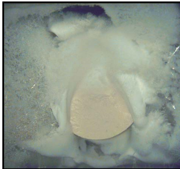
Figura 64. Fotografía de una probeta de circonón calcinada a 1450°C/3h rodeada de aluminio, tal y como sale del horno.
