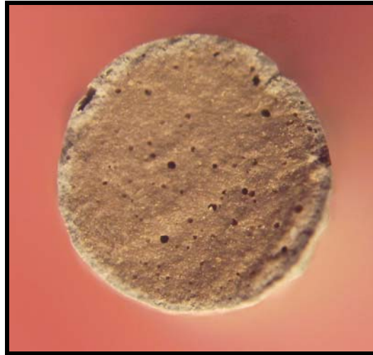
Figura 101. Fotografía de la fractura de un cilindro de circonón calcinado en N 2
