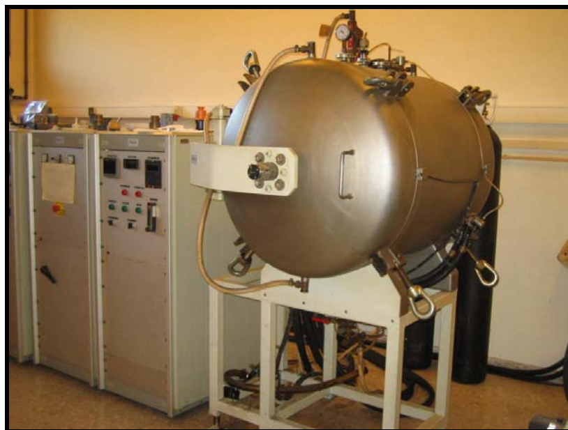
Figura 23. Horno Pyrox HI-16L/17 de paredes de grafito
