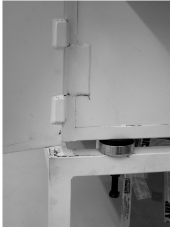
Figura 4.2: Foto de uno de los tornillos de nivel en la base de la cabina.
