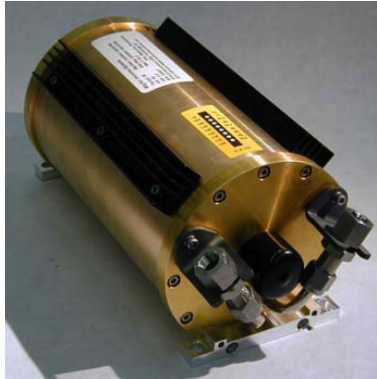
Figura 2.3: Foto del tubo del sistema de tomografía.
