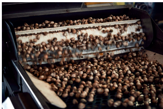
Imagen 49. Cinta clasificadora en la lonja de Noia. Fotografía realizada por Explorer Eyes.
