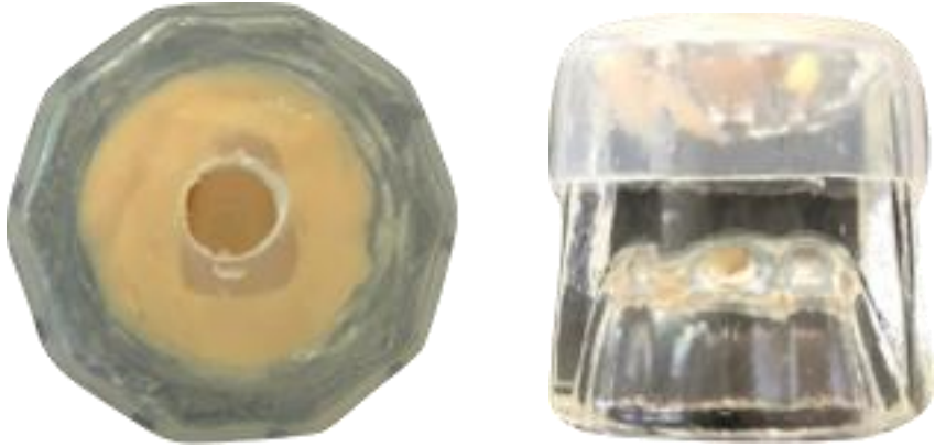
Figura 13. Portamuestras confeccionado para el registro de color de las muestras de la guía VITAPAN Classical ® en visión frontal y lateral.
