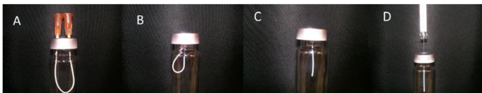
Figura II.B.7. Dispositivos de extracción más comunes para la extracción mediante HF-LPME: en disposición U (A,B), en extremo cerrado (C,D) y con (A,D) o sin (B,C) disolvente en su interior.
