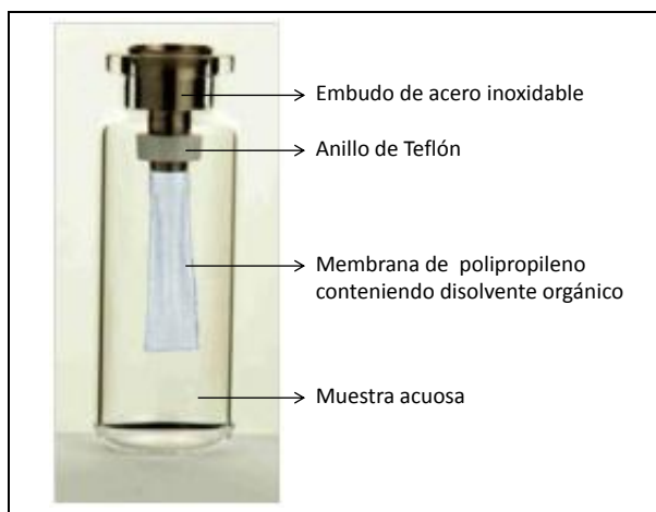
Figura II.B.8. Dispositivo comercial utilizado para extracción con disolventes asistida por membranas (MASE).
