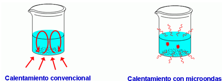
Figura 1.6 Transferencia del calor desde las paredes al interior del recipiente
