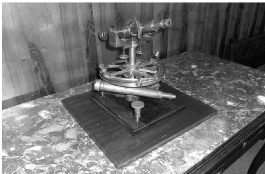
Fig. 2. Teodolito proporcionado por Rodríguez dende París e usado por Fontán na elaboración da Carta Xeométrica de Galicia.
