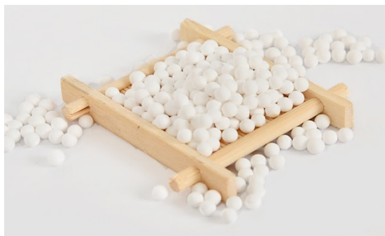
Figura 49. Catalizador de \text{Ni}/\text{Al}_2\text{O}_3 para hidrogenación [50].
