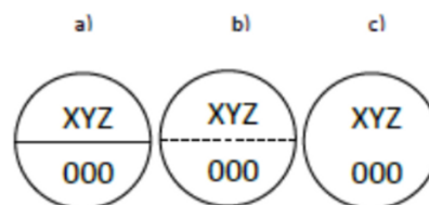
Figura 55. Nomenclatura de los elementos de control.
