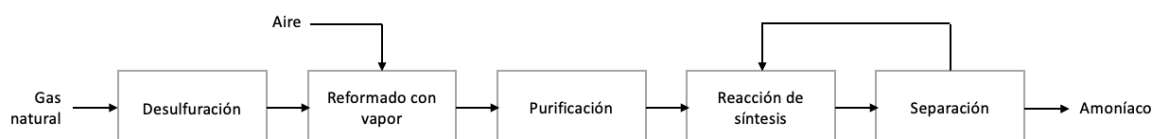
Figura 2. Diagrama de bloques del proceso de producción de amoníaco. Elaboración propia.
