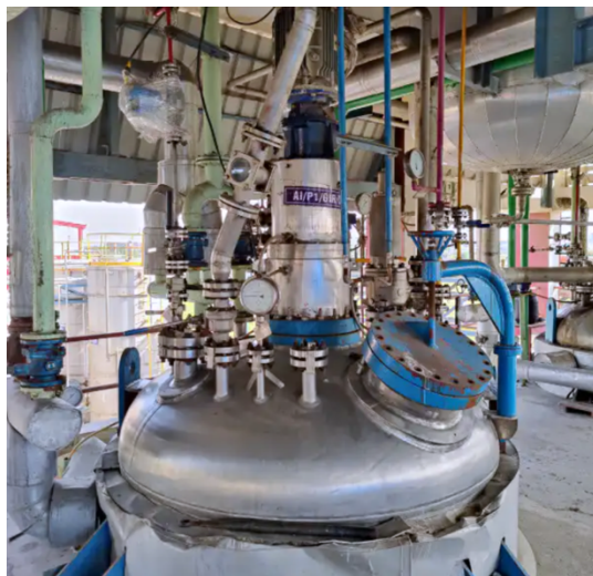
Figura 48. Reactor de hidrogenación catalítico industrial proporcionado por el fabricante Aeidan Industries [49].
