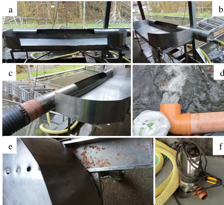
Figura 11: Selección de los ejemplares. a. Mesa de selección de los ejemplares de trucha hembra reproductora; b. Inicio del sistema de tuberías con el punto de entrada de agua en las mismas; c. Punto de salida de las truchas inmaduras o maduras sin presencia de huevas en su interior a través del sistema de tubos; d. Porción final del sistema de tubos a través de la cual las truchas son devueltas al estanque; e. Sistema de recolección de las huevas que puedan permanecer en la mesa de selección; f. Bomba de agua empleada para la extracción de agua del estanque para su inclusión en el sistema de tuberías de la mesa de selección. Fuente: Elaboración propia.
