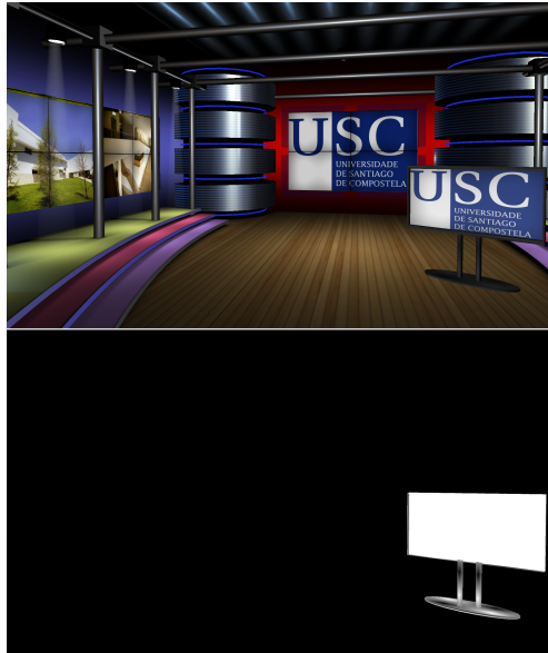
Figura 2.6: Escenario en el que una pantalla virtual se sitúa por delante del mundo real y máscara alfa codificando su posición relativa
