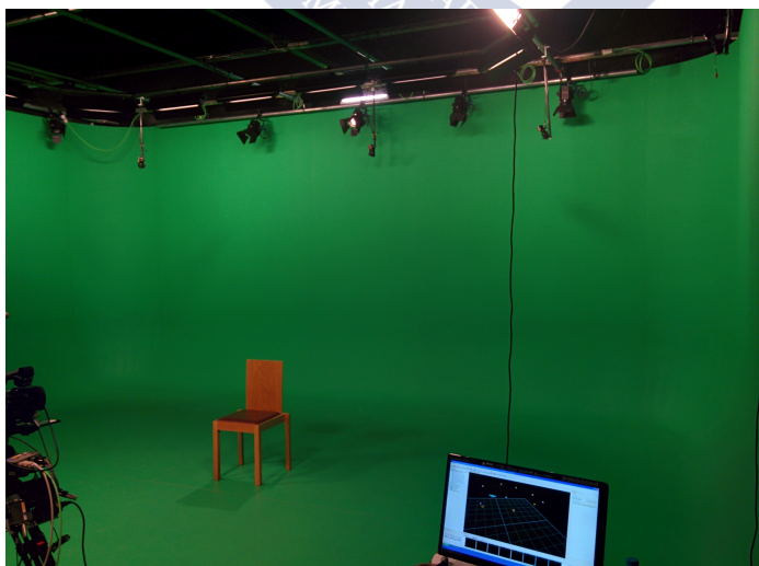
Figura 4.8: Sistema de 8 cámaras Optitrack y Tracking Tools instalados en el plató
