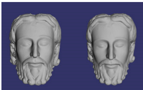
Figura 6.2: Izquierda: datos sin simplificar de la cabeza del Apóstol Santiago (+300K Vértices). Derecha: simplificación al 70%.
