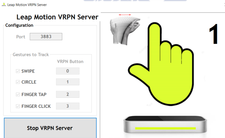
Figura 4.16: Interfaz gráfica implementada para el servidor VRPN de Leap Motion en el momento de la detección del gesto swipe
