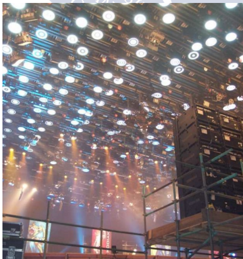
Figura 2.12: Marcadores situados en el techo utilizados en una sensorización inside-out de la BBC
