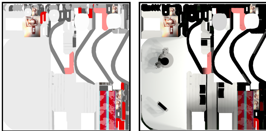
Figura 5.12: Textura sin información adicional (izquierda) y textura con información de iluminación global tras un proceso de baking (derecha)
