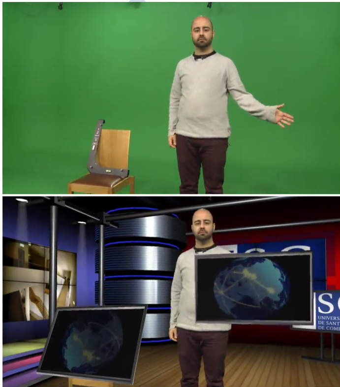
Figura 4.17: Actor manipulando un objeto virtual a través de la sensorización proporcionada por el Microsoft Kinect
