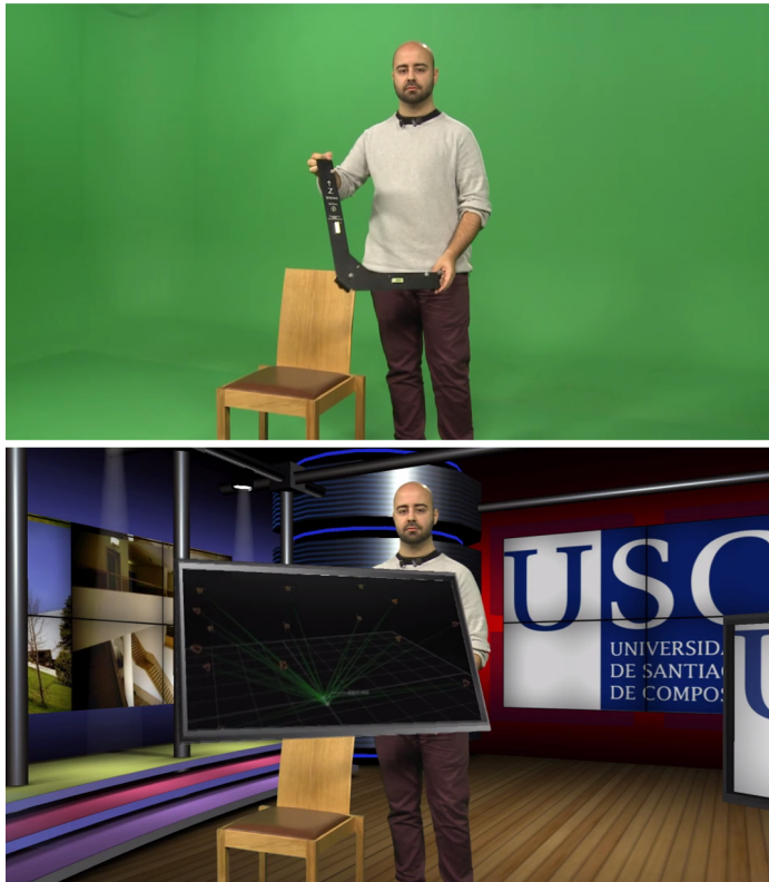
Figura 4.10: Manipulación de una pantalla a través de una interfaz tangible basada de sensores Optitrack
