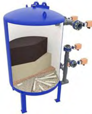
Ilustración 5: Disposición de capas en filtro de arena (Fuente: www.es.brotherfiltration.com )
