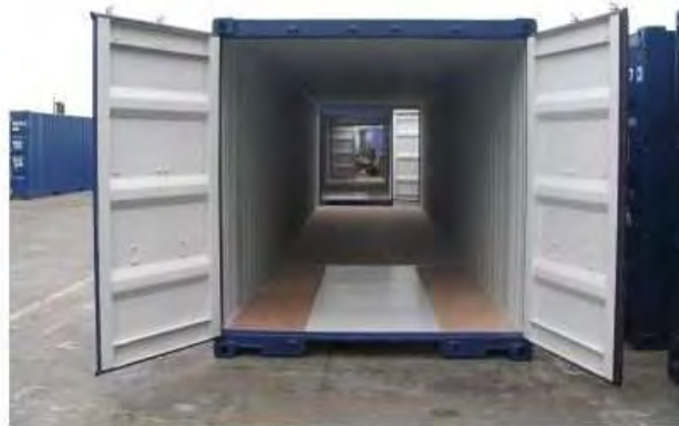
Ilustración 16: Modulo (contenedor 40 pies) para instalación de UDAM
