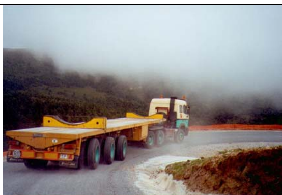
Figura II.39. Detalle de un camión de transporte de las secciones que componen la torre, con caja provista de los dispositivos adecuados para el amarre del elemento al remolque. Parque eólico Ventoada.
