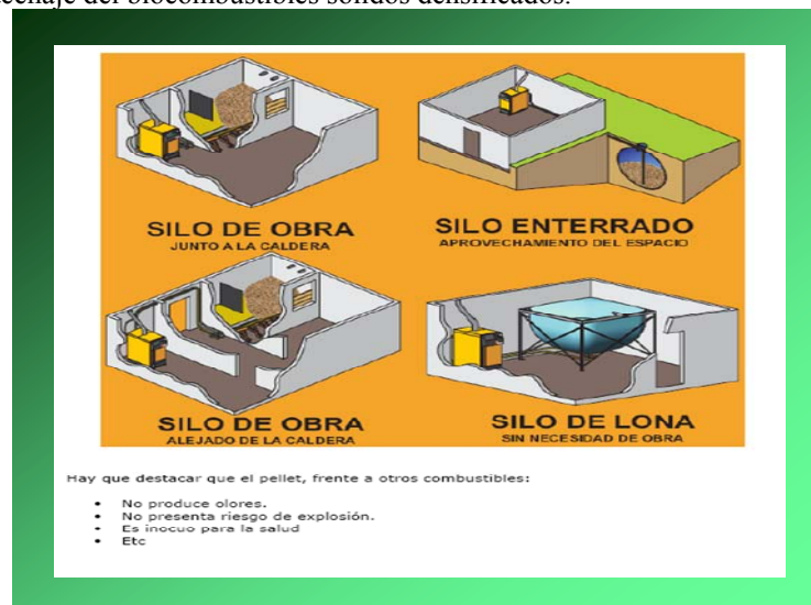
Figura 12. Esquema de soluciones constructivas para almacenaje de pellets.
