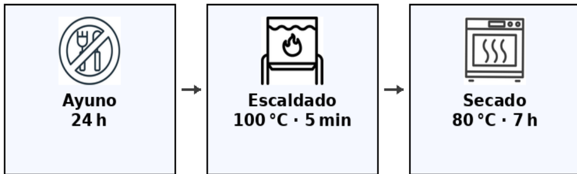
Figura 8. Ilustración del proceso para la comercialización de las larvas de Tenebrio molitor según el Reglamento de Ejecución (UE) 2021/882 (Metodología adaptada de José Carlos Ribeiro et al., 2024)
