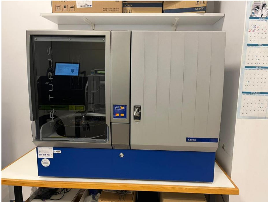
Figura 16: Equipo Triturus®. A: Analizador ELISA automatizado
