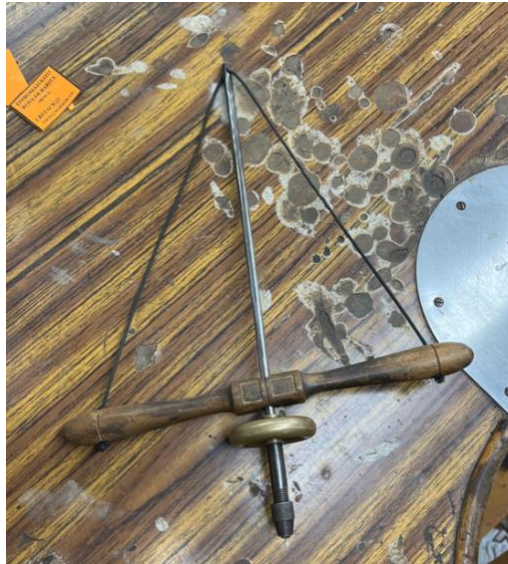
Figura 64: Trépano de volante. Fonte: Fotografía Olivia Illán Lorenzo [22/04/2025]
